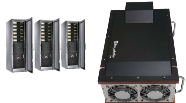
Aufgebautes 3 kWh-Prototypenmodul mit aktiver Luftkühlung, bereit für die Integration in ein Batteriesystem © Fraunhofer IISB / www.Rittal.com
